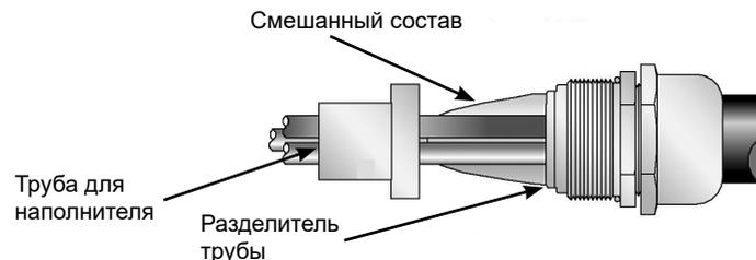
6. Оденьте трубку для наполнителя (3) на провода пока конец не достигнет разделителя трубы (5). Полностью заполните составом трубку.
