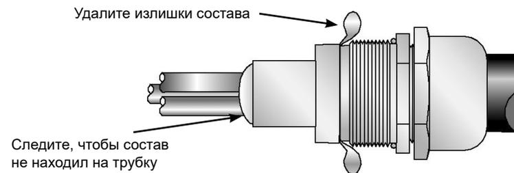
7. Немного ослабьте кольцо внешнего уплотнения. Установите кабель обратно на элемент ввода. Следите, чтобы состав не оставался на месте и полностью затяните основной элемент (6) на элементе ввода (2). Полностью затяните внешнее уплотнительное кольцо (9). Условия полного закручивания:
